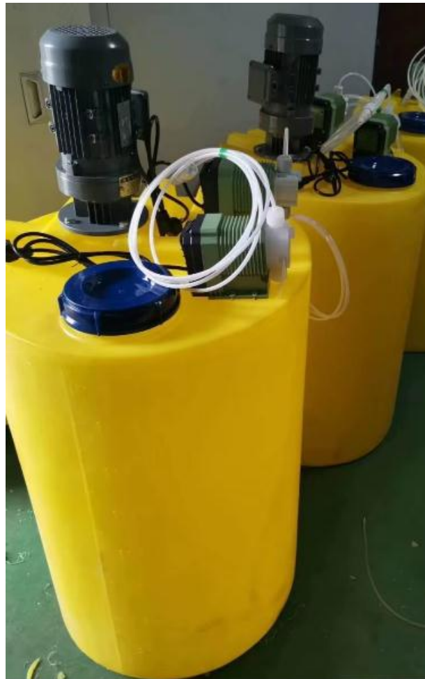
Doseur de chlore automatique à titre de démonstration. (Source internet)
